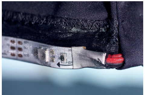
Abb. 7: Details des E-Mantels. Links: LED-Matrix; Stromversorgung/unterer Saum. Rechts: appliziertes Solar Modul Option 3 ; Gewebe mit lichtleitendem Material; MP3-Lilipad auf angestecktem Patch; LED-Band unter Chiffon/unterer Saum. Fotos: Wolfgang Sparenberg, 2018.
