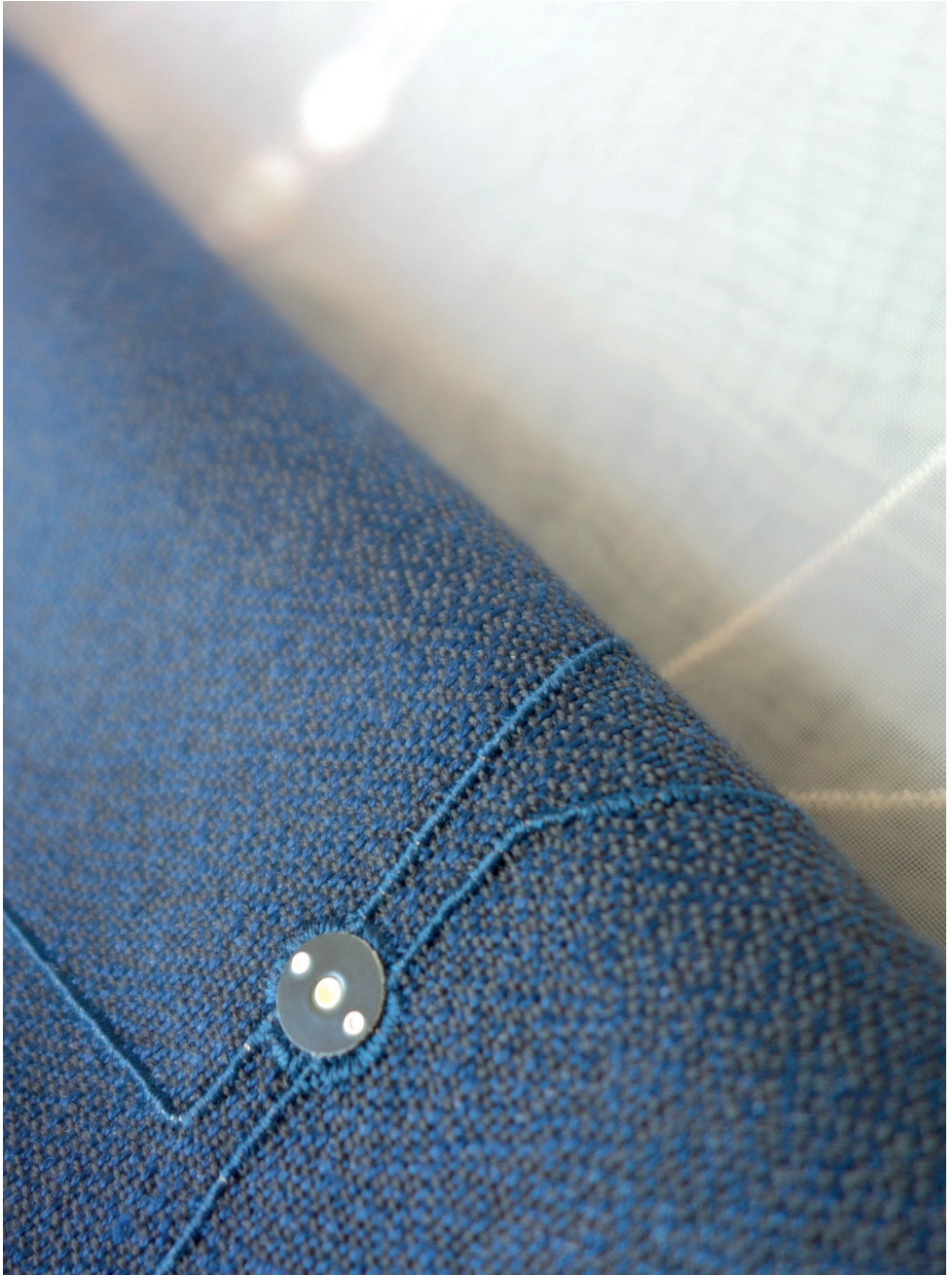
Abb. 12: LED-bestickte Textilien der Schweizer Firma Forster Rohner , Sparte Textile Innovations . Foto: Lucia Schwalenberg, 2019.
