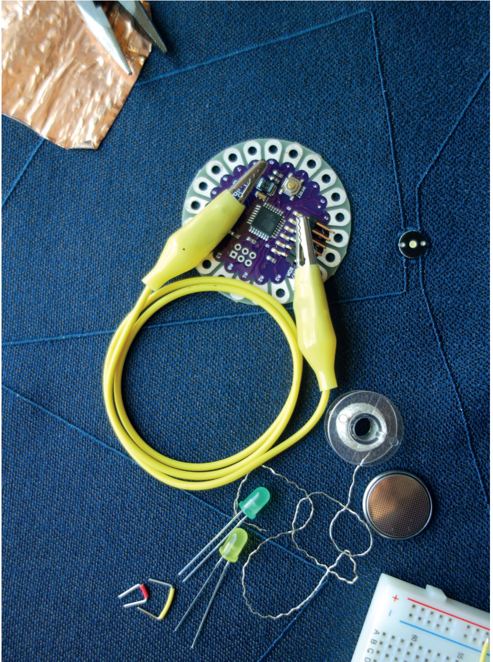
Abb. 3: Arbeitsmaterial: u.a. LED-Lampen, leitfähiges Garn, Knopf-Batterie, Abgreifklemme, Breadboard, LED-bestickter Stoff/ Forster Rohner . Foto: Lucia Schwalenberg, 2019.
